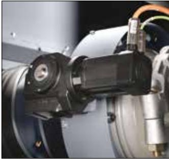
Die Komponenten sind für eine hohe Wirkung in der ersten Stufe positioniert und passen die Kapazität des Volumenstroms (FAD) mit einem konstanten Enddruck im Regelbereich dem genauen Druckluftbedarf an. So können Energieeinsparungen von bis zu 9 % im Vergleich zur herkömmlichen Ventilregelung erzielt werden. Der zuverlässige, auf einem Servomotor basierende Stellantrieb für präzise Reaktion auf den schwankenden Druckluftbedarf sichert diese Energieeinsparung.
